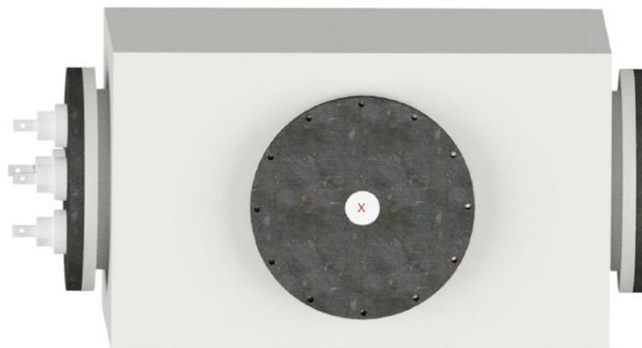
Abbildung 3-1: Druckfestes Prüfgefäß (Nachbildung eines NS-Schaltanlagen Schottraumes)
