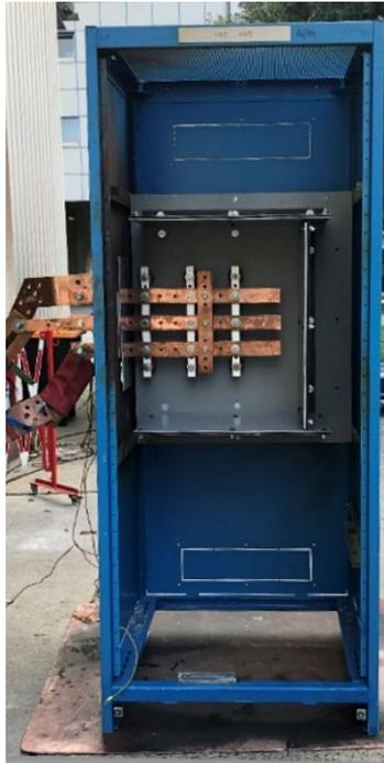
Abbildung 3-2: Schaltfeldanordnung mit horizontalen Sammelschienen
