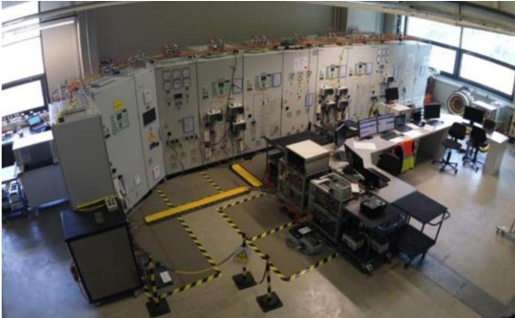
Abbildung 78: Prüfeinrichtung nach dem Transformatorumschaltungsprinzip
