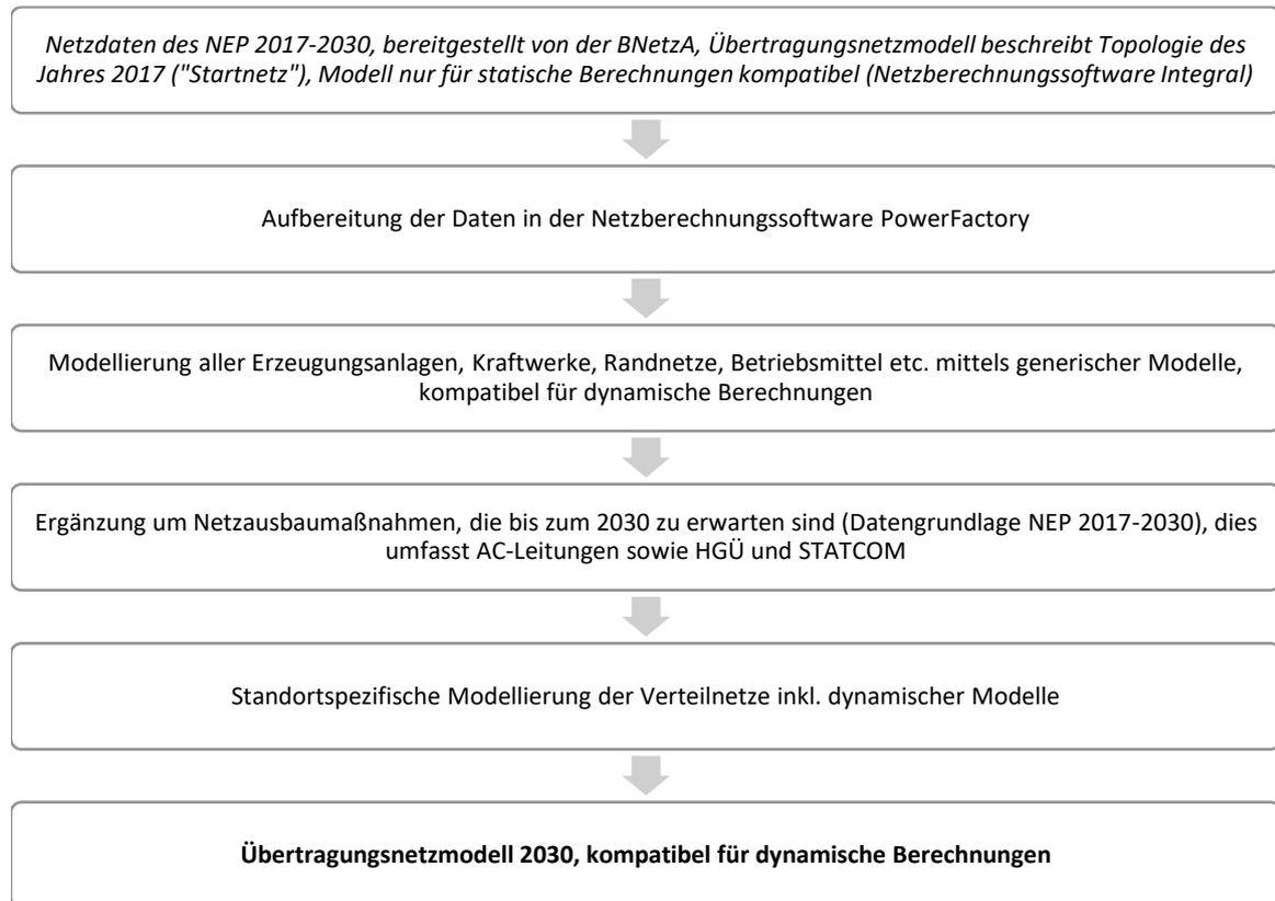
Abbildung 17: Prozess der Modellierung des Übertragungsnetzes auf Basis der Daten des NEP 2017-2030
