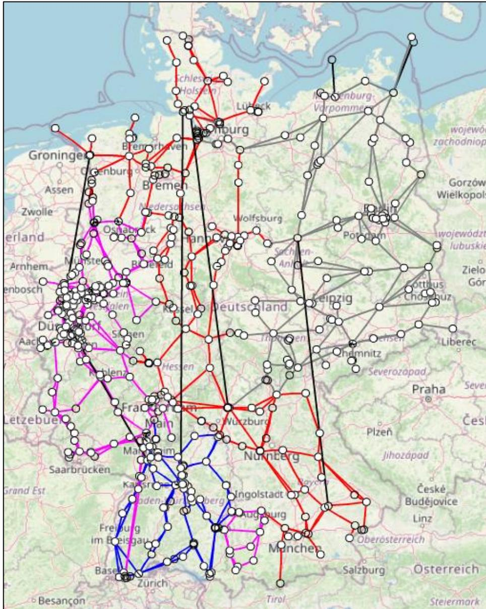
Abbildung 15: Aufbereitetes und weiterentwickeltes deutsches Übertragungsnetzmodell auf Basis von Daten der BNetzA und des Netzentwicklungsplans für das Jahr 2030 in der Simulationssoftware PowerFactory
