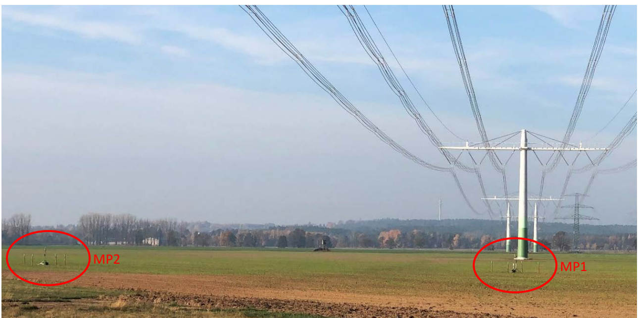
Bild 2 Koronageräuschmessung mit Messpunkt direkt unterhalb der Leitung (rechts) und zweitem Messpunkt zur Fremdgeräuschkorrektur (links)
