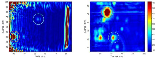
Ebenso werden Schwankungen in den Wanddicken einzelner Schichten innerhalb des Prüfstückes visualisiert.
