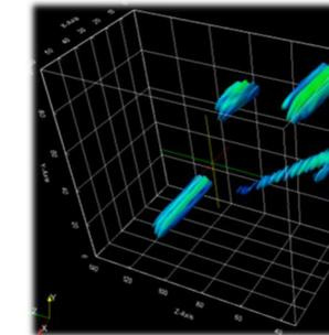
Bild 4: 3D-Darstellung von Einschlüssen in Kabelisolierung
