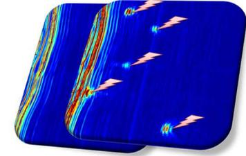
Bild 3: Einschlüsse in Kabelisolierung
