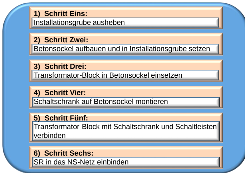
Abbildung 5.2: Ablauf der Installation des Strangreglers
