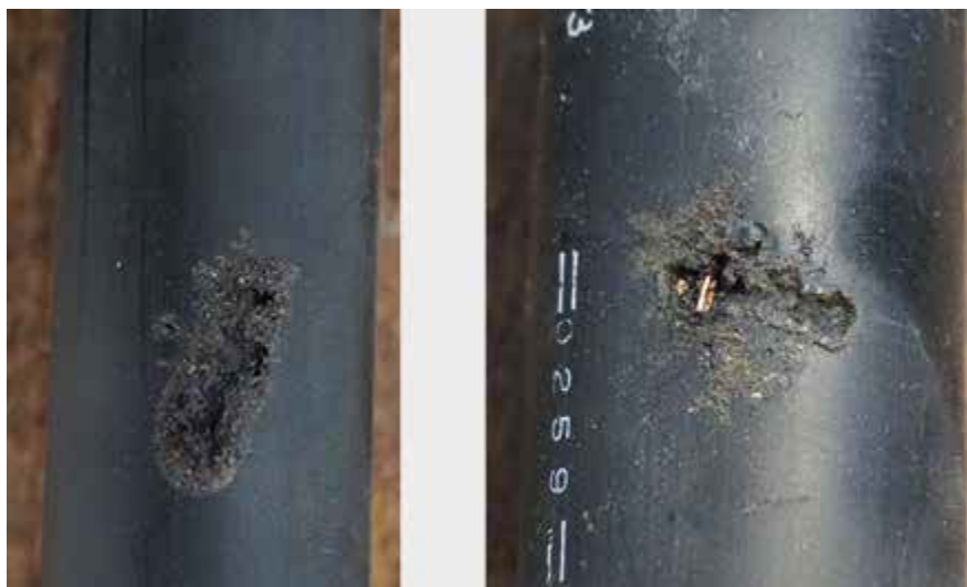
Bild 1 Typische Kabelmantelschäden nach Ortung
