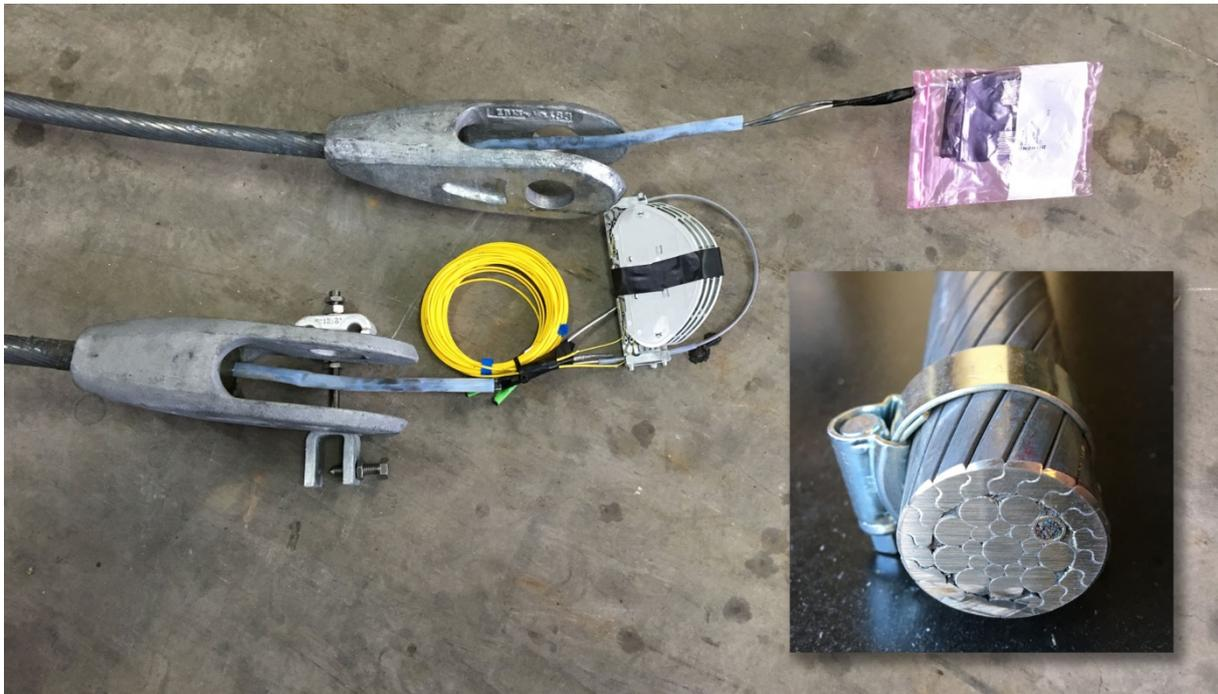
Bild 2 Sondererdseil mit herausgeführten Lichtwellenleitern
