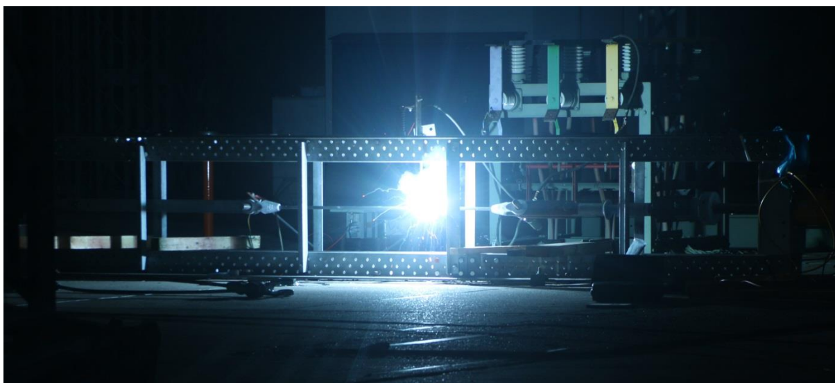
Bild 3 Simulierte Blitzeinschlagprüfung an mit hoher Zugkraft gespanntem Stahltragseil
