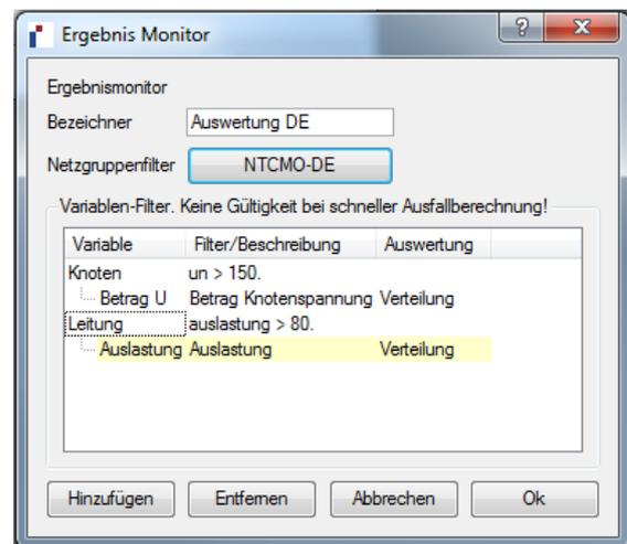
Bild 1 Ergebnismonitor zur Reduktion der Datenmenge bei Zeitreihenrechnungen
