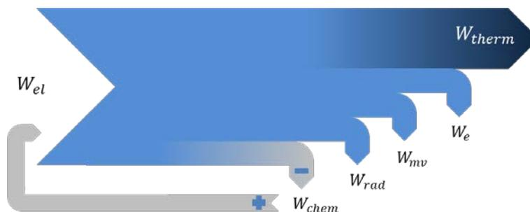
Abbildung 3.1: Schematische Darstellung der Energiebilanz eines Störlichtbogens
