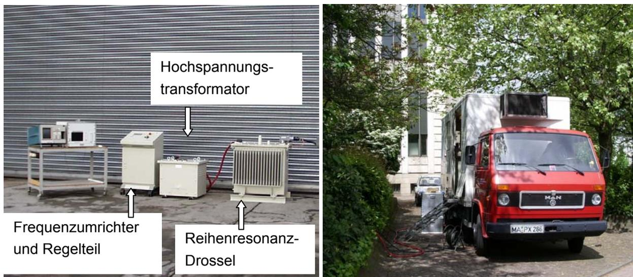
**Abb. 5.3: Einzelteile des Resonanz-Prüfsystems (links) und Messwagen bei der Vor-Ort-Messung (rechts)**
