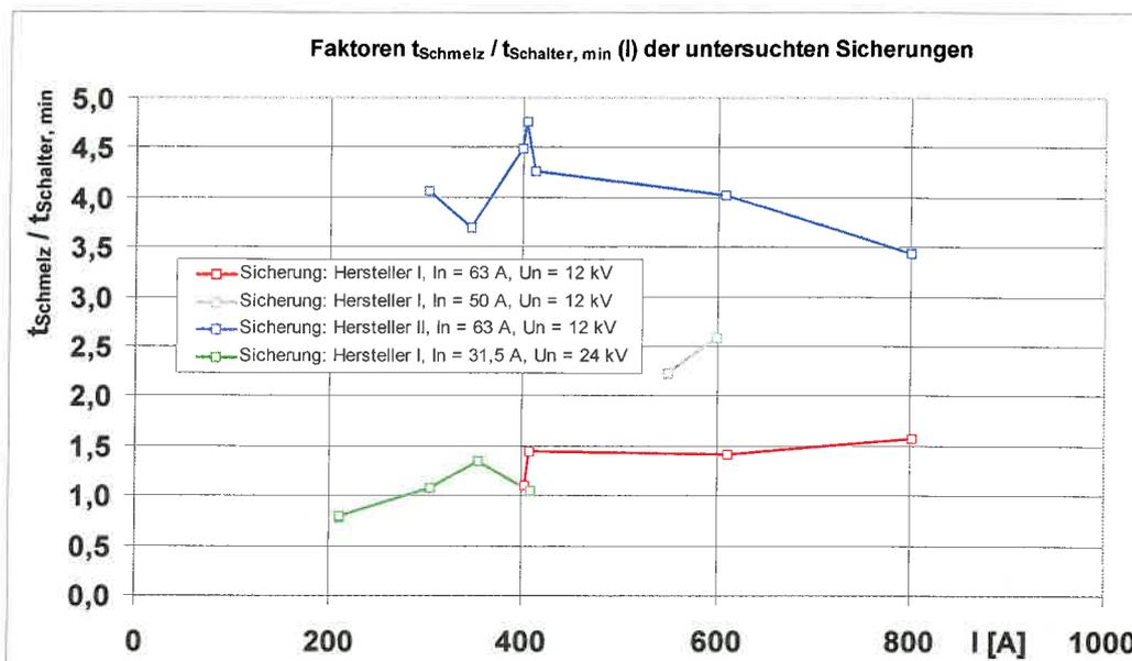
**Bild 7.5** Faktoren  $t_{\text{Schmelz}} / t_{\text{Schalter, min}}(I)$  für die kürzesten Öffnungszeiten  $t_{\text{Schalter, min}}$  der Lastschalter zur Bestimmung der Übernahmeströme an der Schmelzkennlinie der untersuchten Sicherungen
