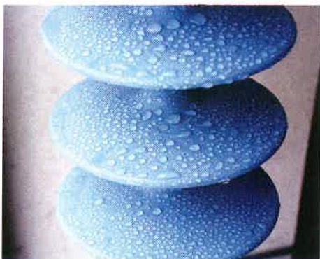
Bild 17 Serie 2: Betauung mit geringer Leitfähigkeit. Hydrophobie der gereinigten Oberflächen nach dem Ansprühen mit Wasser.
