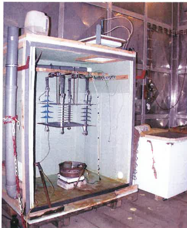
Bild 5 Isolierte Prüfzelle für Batauversuche mit Prüflingen und Wasserbehälter.
