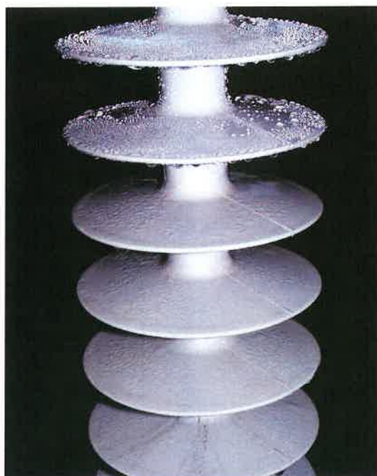
Bild 27 Ungleichmäßige Verteilung der Oberflächenleitfähigkeit im Laborversuch.
