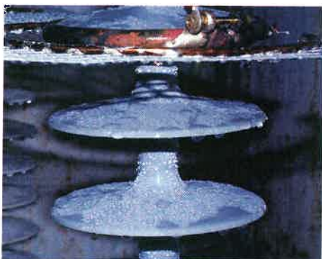
Bild 8 Serie 1: konstante Fremdschichtbeanspruchung mit Nebel ohne Leitfähigkeit. Hydrophobieverlust nach einer Versuchsdauer von 114 Stunden.
