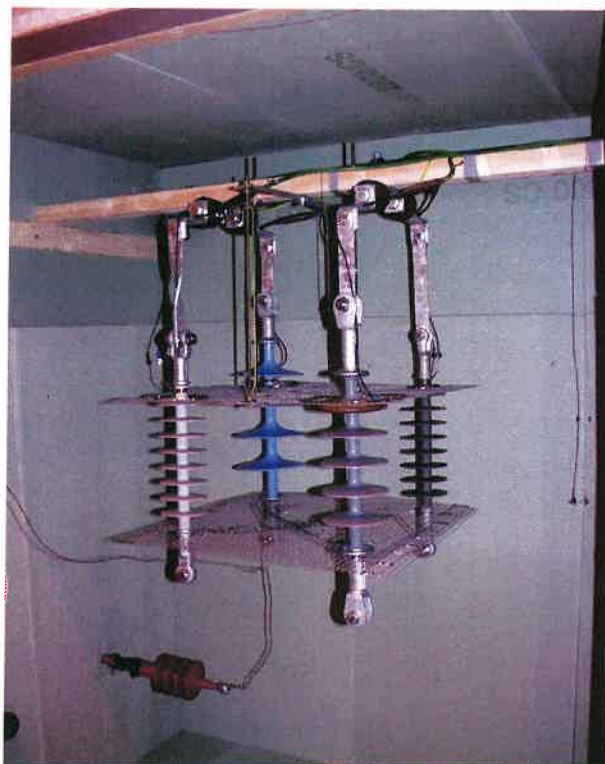
Bild 7 Anordnung der Mittelspannungsisolatoren für die Dauerversuche am Beispiel der Betauungsversuche.
