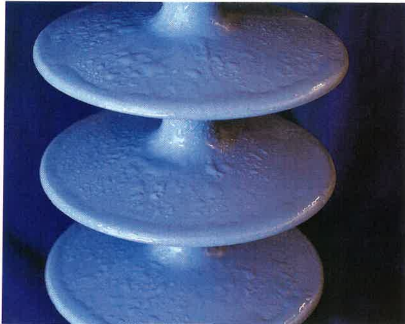
Bild 9 Serie 1: konstante Fremdschichtbeanspruchung mit Nebel ohne Leitfähigkeit. Hydrophobieverlust bei Prüfling C nach einer Versuchsdauer von 785 Stunden.
