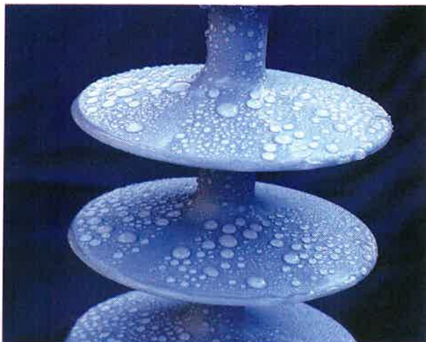
Bild 3 Tröpfchenbildung auf den Silikonoberflächen im Neuzustand.
