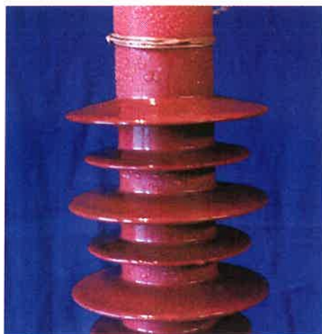
Bild 25 Tröpfchenbildung auf den natürlich verschmutzten Silikonisolatoren nach dem Betauungsversuch.
