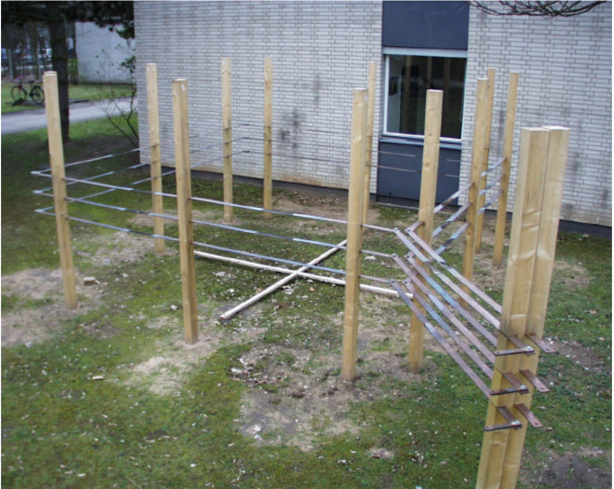
Bild 3.2: Ansicht der Referenzanordnung zur Messung und Berechnung der magnetischen Felder von Drehstromanordnungen
