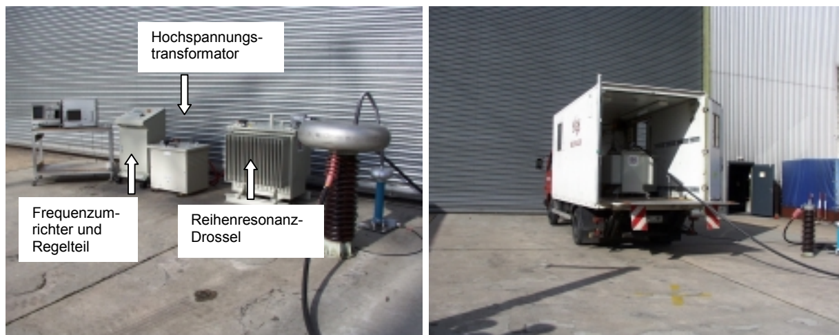
Bild 4.3 Ansichten des Resonanz-Prüfsystems als Einzelelemente (links) und nach Einbau im Transport- und Messwagen (rechts)
