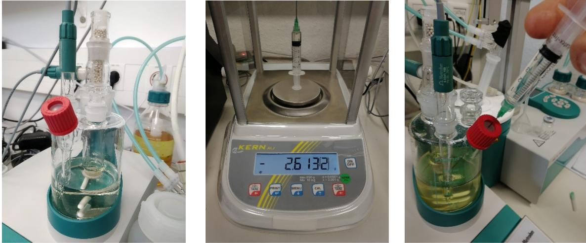
Abbildung 41: Referenzmessung: Direkttitration während eines Befeuchtungsprozesses
