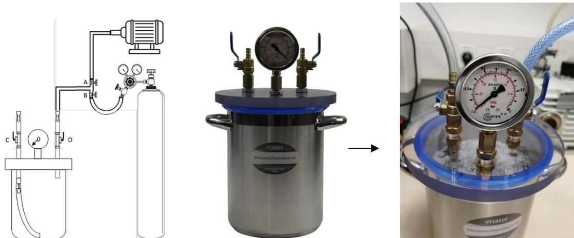
Abbildung 50: Realisierung eines Entgasungssystems (links) mit Vakuumfalle (Mitte/rechts)
