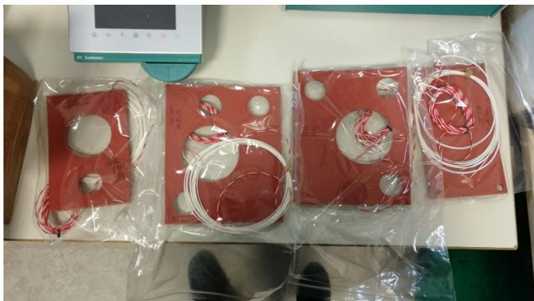
Abbildung 7: Heizmatten mit integrierten Temperatursensoren für die Temperaturregelung
