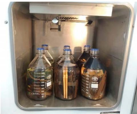
Abbildung 61: Alterung von Isolierölproben im Ofen bei 110 °C
